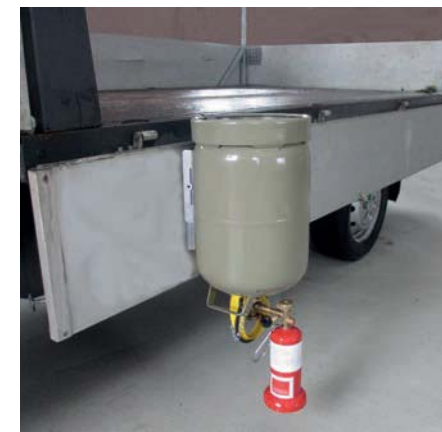
■ Umfüllvorgang an aufgeklappter Ladebordwand auf der Baustelle
