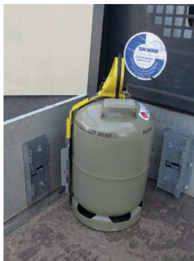
■ Gasflasche mit an der Ladebordwand montiertem Wandhalter
